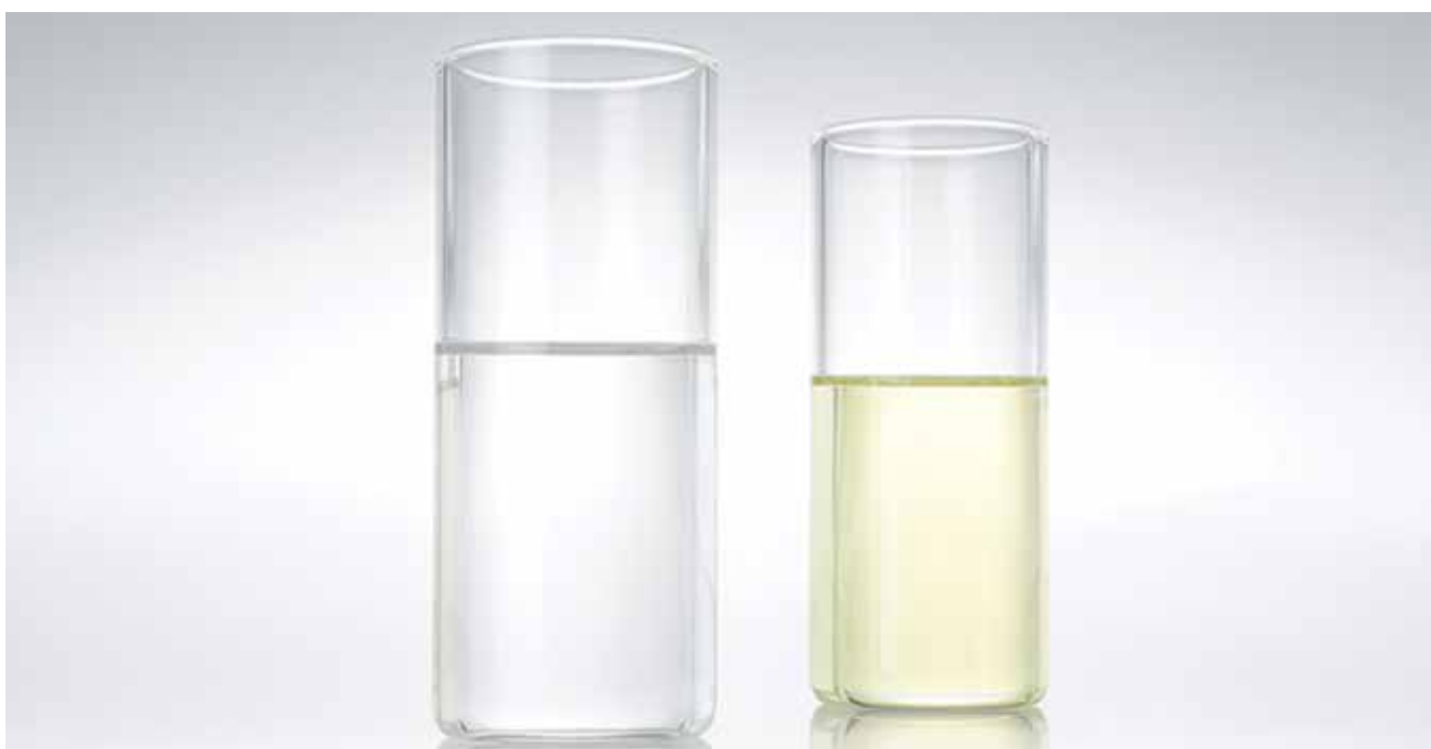
FARBVERGLEICH VON GTL (LINKS) UND DIESEL (RECHTS)
